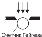
Рис. 43. «Окно» для счетчика Гейгера
